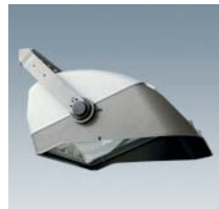
Figura 4. Schermo su tre lati per faro, permette di elevare l'inclinazione fino a 40° tagliando il flusso verso il cielo.
