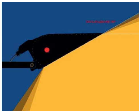
Figura 2. Faro asimmetrico con lampada a lato parabola.
