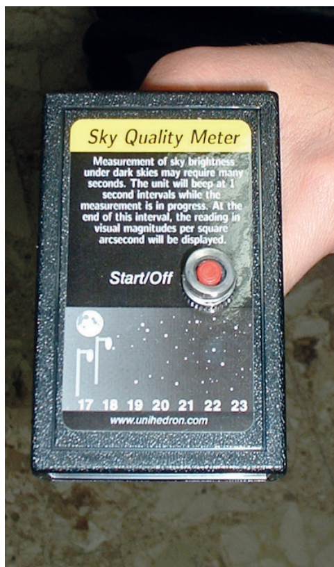
Figura 2. L'SQM (Sky Quality Meter) per la misurazione della brillantezza del cielo.
